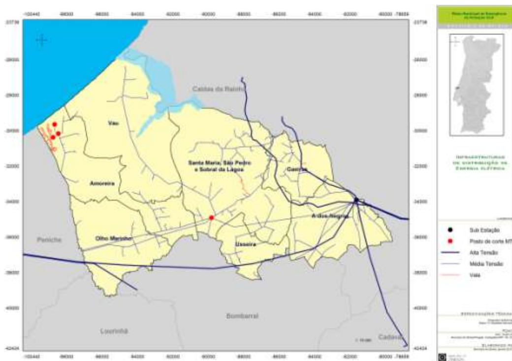
Figura 41 – Carta de infraestruturas de distribuição de energia
