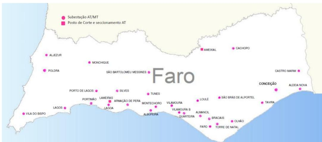
**Figura II. 14 – Subestações e Postos de Corte e Seccionamento de Alta Tensão localizadas na região do Algarve**
